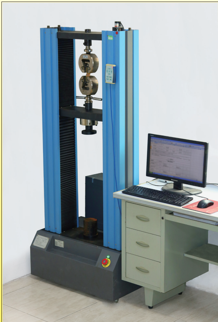
Resistenza alla trazione e allungamento a rottura
