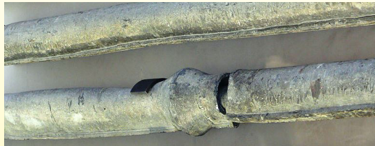
Tubo dell'acqua romano, realizzato con strisce di piombo saldate (Museo di Arles e della Provenza antica).
